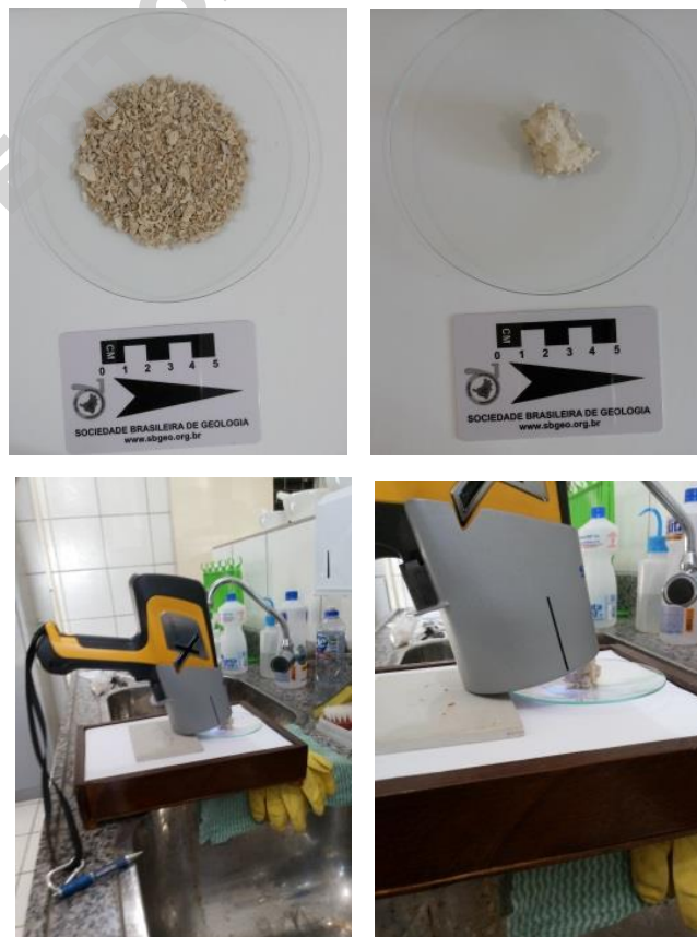
Fluorescência de Raio X em sedimentos marinhos do projeto Plataforma Rasa do Ceará Oeste.
